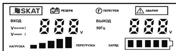
Рисунок 3 — Светодиодный графический индикатор.
